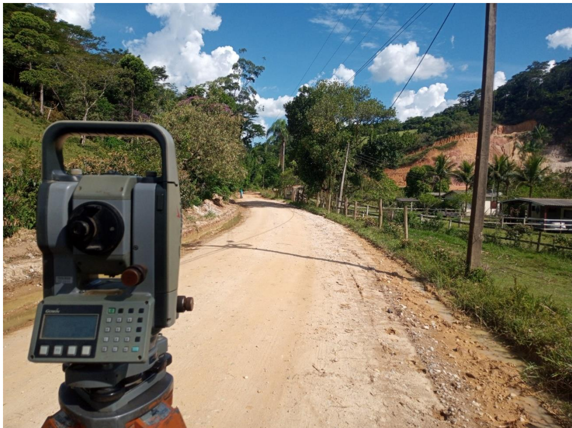
Fotos Registrada em Campo ESTAÇÃO TOTAL ( Ft. 03)
