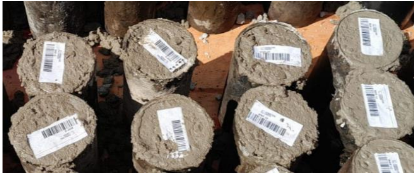
Figura 04 - Patologia - FCK não atingiu o valor de projeto com 28 dias de cura
