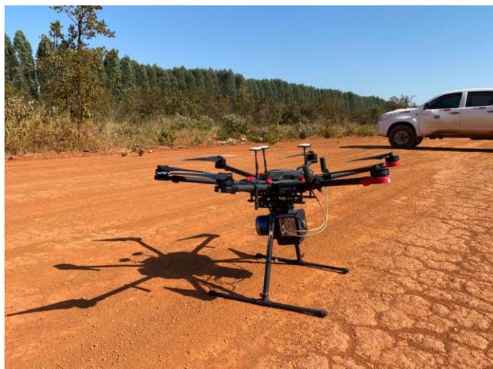
A escolha da realização do levantamento topográfico empregando o uso de drones, faz com que seja possível realizar voos abaixo das nuvens, implicando numa distância menor entre a aeronave e o solo, ao contrário da aeronave tripulada e de
