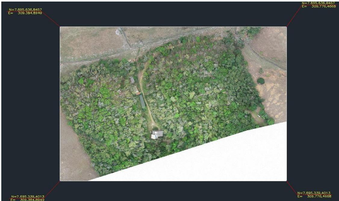
Para a realização desses levantamentos topográficos na fase inicial de execução das medições, utilizou-se em paralelo à implantação dos marcos referenciados e dos alvos, o sobrevoo com o Drone Phantom 4 Pró e o Drone Matrice 600 Pro em conjunto com o Laser LiDAR IT Explorer R foi realizado ao longo da área de estudo.
