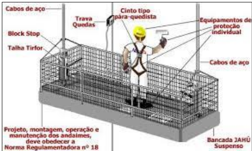
Figura 7 - Andaimos suspensos mecânico-leves
