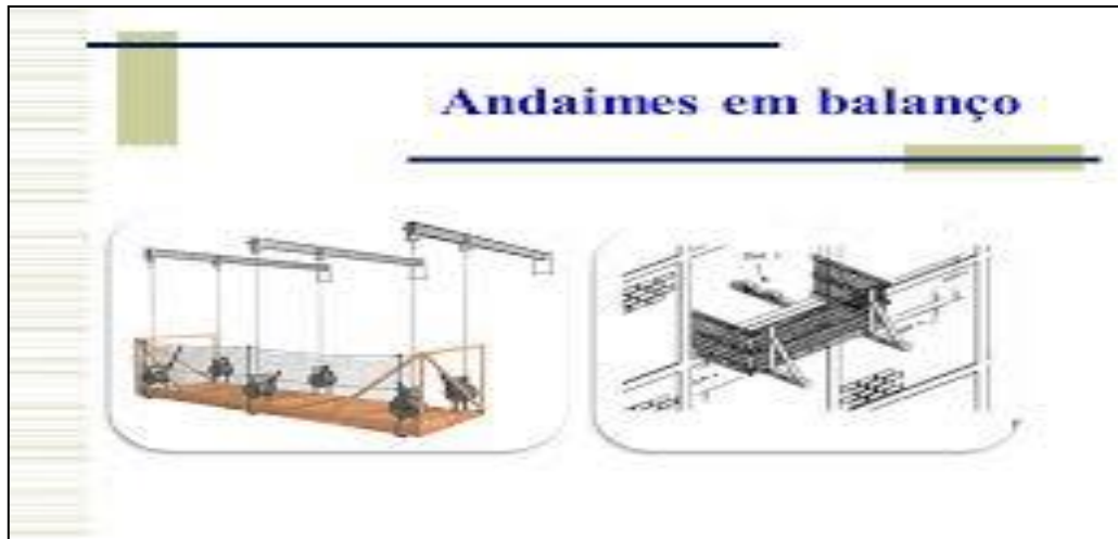
Figura 8 - Andaimos em balanço
