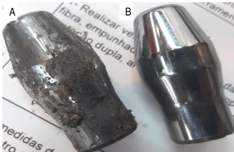
Figura 22 - Ilustração sobre o mandril causador da não qualidade
