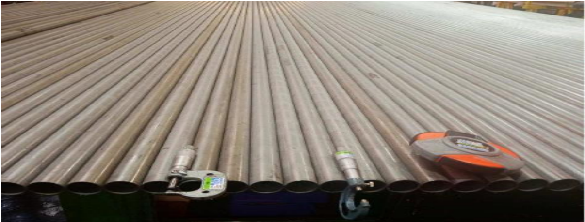
Figura 16 - Tubo em aço sem costura sob inspeção do controle da qualidade
