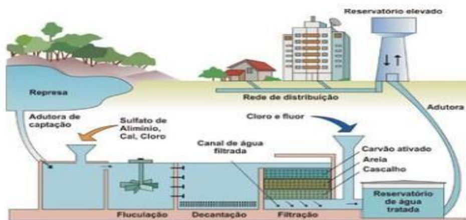
Ilustração – Esquema da coleta, tratamento e distribuição da água
