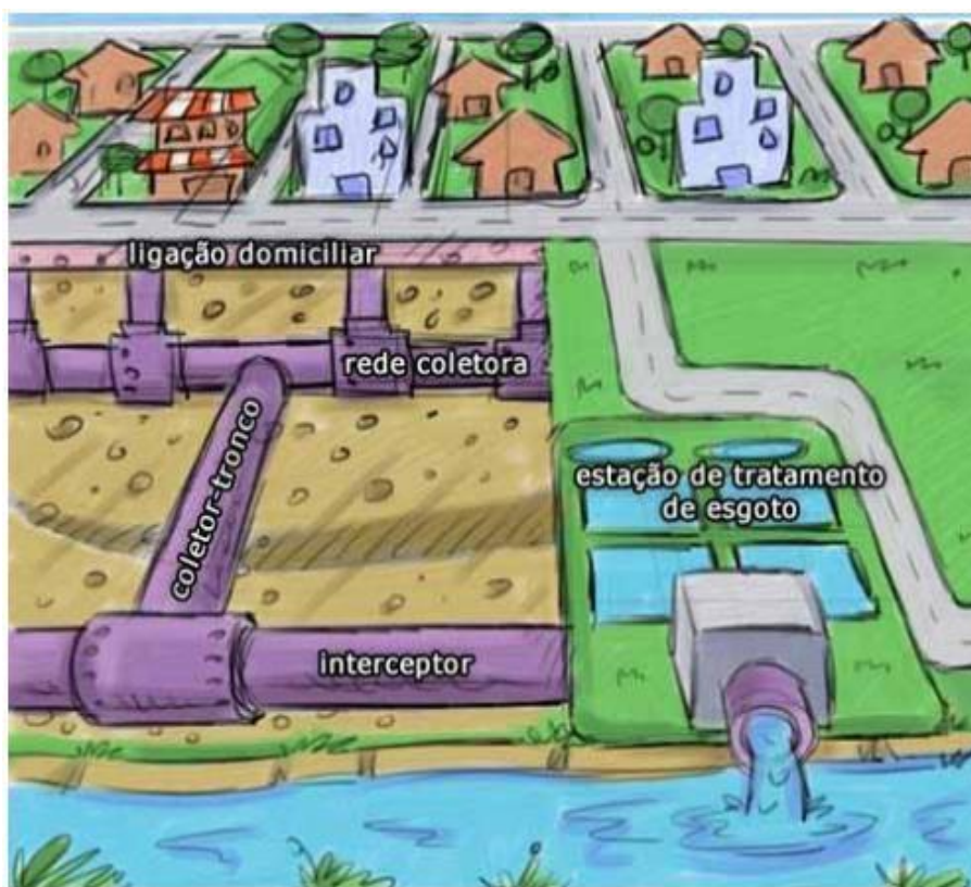
Figura 23 - Tubulações de esgoto e seu destino
