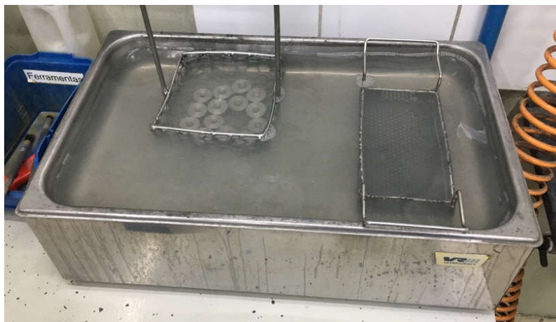
Figura 6 – Lavadora ultrassônica para limpeza das fieiras
