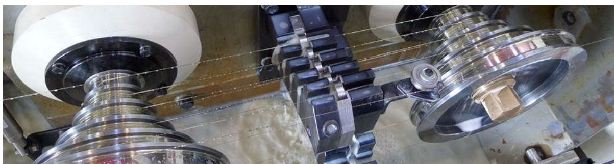
Figura 3 – Exemplo de tanque de trefilação úmida
