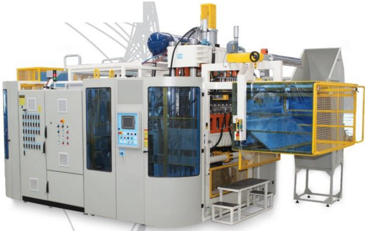
Figura 7 – Termoformadora TE8 utilizada na fabricação de copos descartáveis
